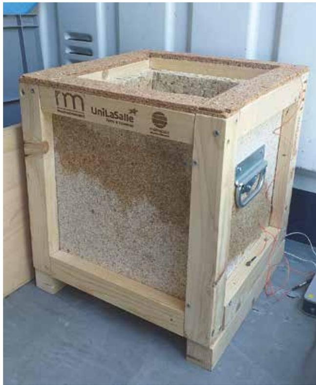
Fig. 4. Prototype de caisse de transport d'œuvres d'art en matériaux biosourcés fabriqué par Y. Zerarka dans le cadre du projet RMM Rouen/ UniLaSalle. © Caroline Biro
